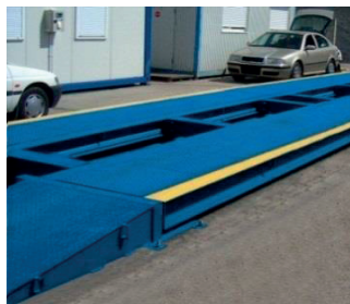
Waga samochodowa stalowa wersja najazdowa z najazdami stalowymi
